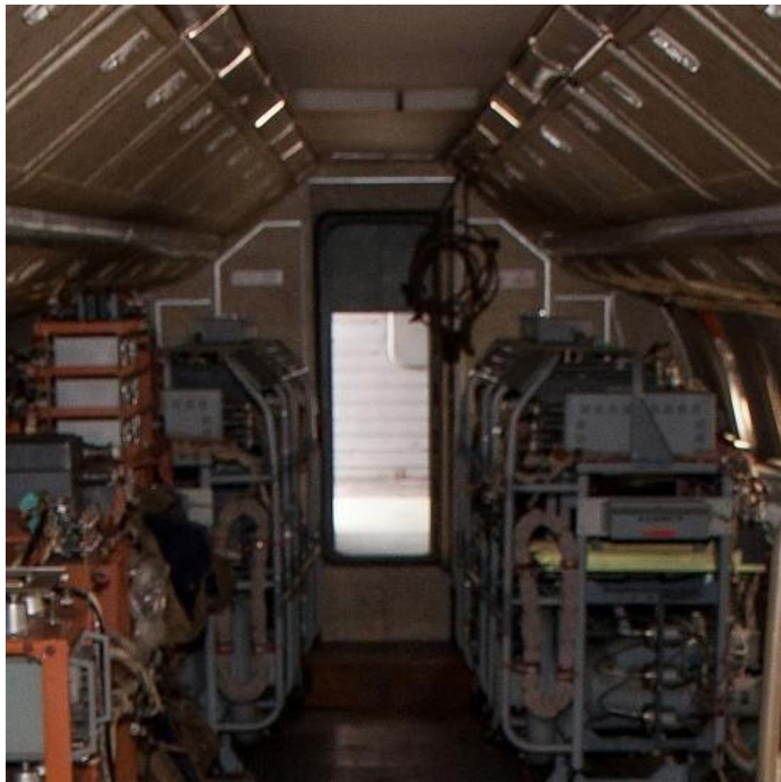
Поднят вопрос по газобаллонному оборудованию, на самолете до сих пор стоят огнетушители, баллоны для надувки трапов, кислородная система и пр. Например, на фото видно что дверь запитана на открывание от баллона, если стрелка в приборе не прикипела, то давление в баллоне до сих пор имеется.
